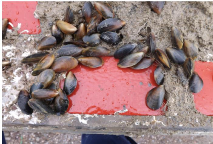
Figure 20 : Photo prise d'un coupon recouvert du revêtement silicone PPG Si 1290, visite d'octobre 2019 (Photo EDF). Extrait de la note d'observation : « Moules autour sur les interstices (entre les coupons) (3 à 4 cm), Revêtement propre »
