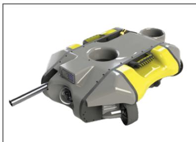
Figure 13 : Le système de jet d'eau cavitationnel MSS Cavitation cleaner de VideoRay (source : VideoRay, <https://www.videoray.com/accessories-options/options/mss-cavitation-cleaner.html>). Le jet d'eau de 150 bars sort par la buse et est appliqué sur la surface à nettoyer. La moindre pression (comparé à un jet d'eau haute pression) permet de préserver la surface.
