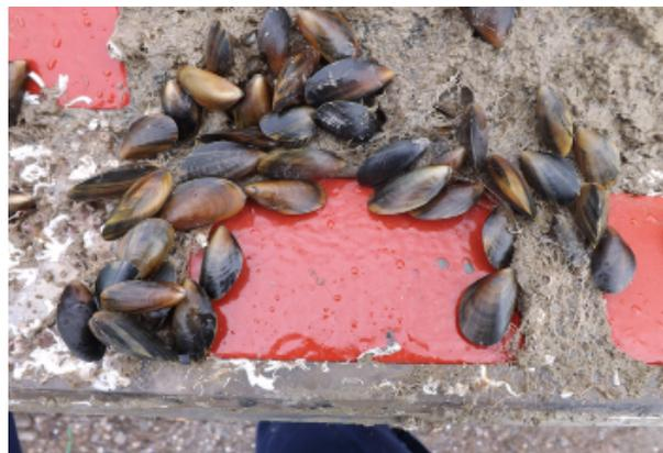
Figure 9 : Photo prise d'un coupon recouvert du revêtement silicone PPG Si 1290, visite d'octobre 2019 (Photo EDF). Extrait de la note d'observation : « Moules autour sur les interstices (entre les coupons) (3 à 4 cm), Revêtement propre »
