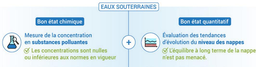
Figure 4 : Détermination de l'état d'une masse d'eau souterraine (Agence Française pour la biodiversité / Réalisation Matthieu Nivresse, 2018)
