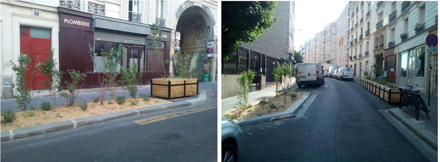
**Figure 25** : De part et d'autre de la rue des Envierges (Paris, 20ème arrondissement), la chaussée a été désimperméabilisée ou garnie de bacs et plantée de fruitiers, dont la gestion revient aux habitants. (Photos : N.Pirard, 2019)
