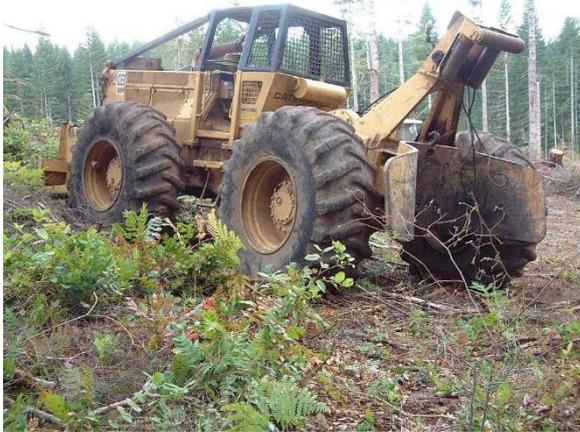
Figure 1: Débusqueur (skidder) à câble (source : wikipédia)
