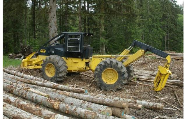
Figure 2: Débusqueur (skidder) à câble plus griffe (source : wikipédia)
