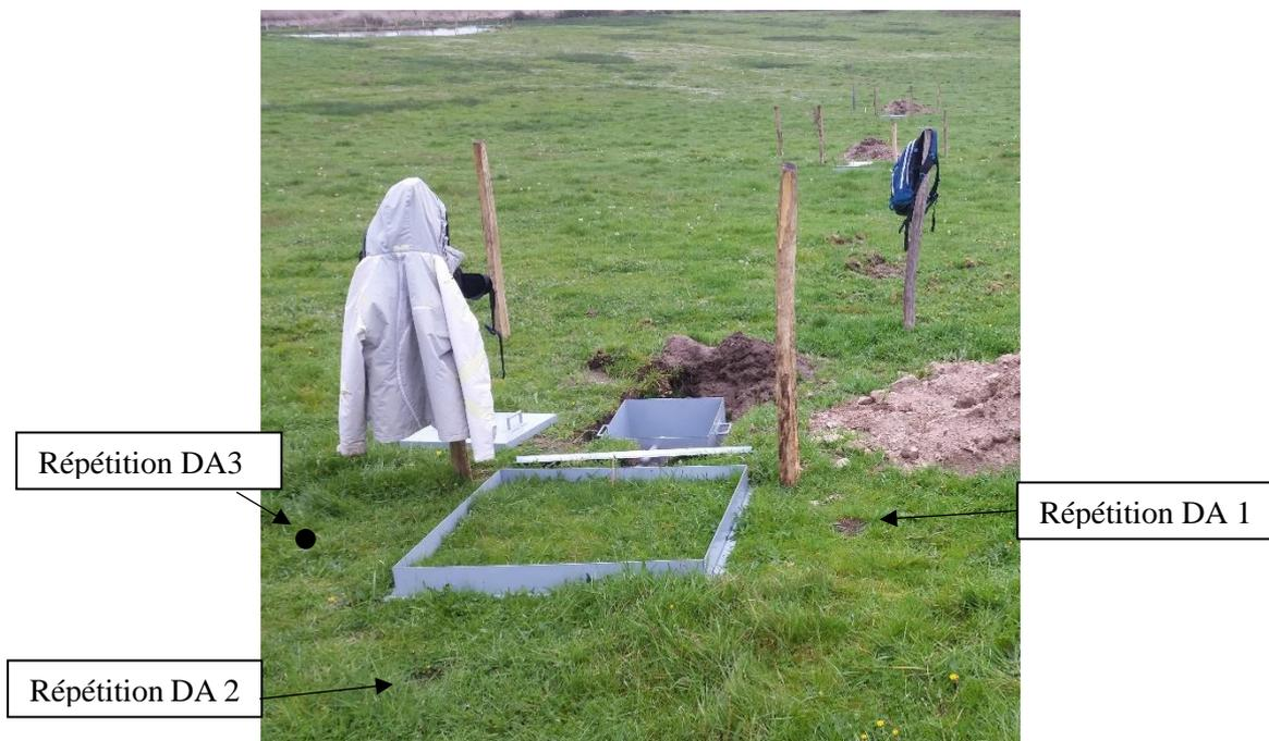
Figure 18 - Photographie de la disposition des prélèvements d'échantillons de terre pour les densités apparentes (DA) par rapport aux micro parcelles
