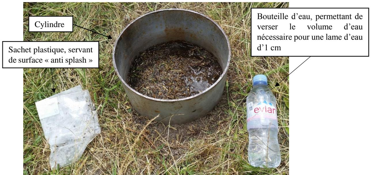
Figure 21 - Photographie du matériel utilisé lors des tests d'infiltration dans le pâturage
