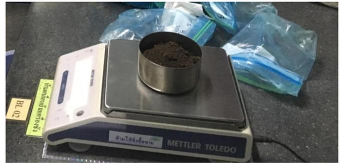
Figure 19 - Photographie des étapes de séchage et de pesage des échantillons de terre pour le calcul de la densité apparente
