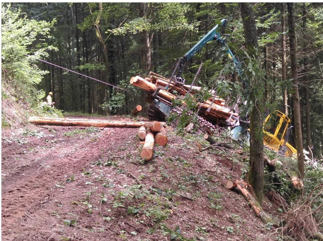
Figure 6 : Porteur avec treuil d'assistance synchronisé en action. Source : Jean-Louis LE CALONNEC
