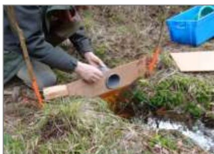
Figure 38 : Dispositif de mesure de débit tuyau  $\varnothing$  100 mm ©F. Zoccarato
