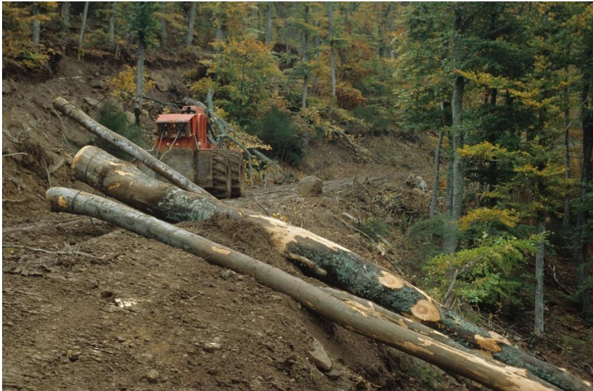
Figure 12 Débardage par tracteur débusqueur. Source : ONF
