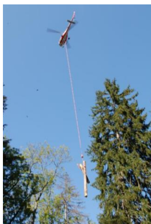
Figure 16 Débardage par hélicoptère. Source : Hélicoptère Luchon 2
