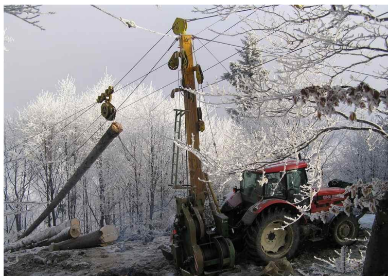
Figure 14 Débardage par câble-mât. Source : Müller-Câble-Mât
