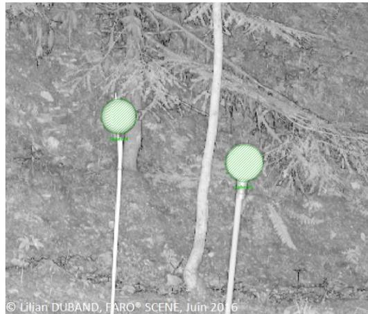
Comme dans toute détection automatique il y a des oublis (omissions) et des « inventions » (comissions). Une étape de filtrage manuel est donc nécessaire. Une fois les sphères correctement détectées, le logiciel recale les différents scans en une zone cohérente.
