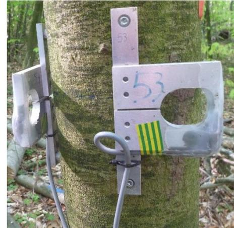
Figure 15 : Capteurs de déformation
