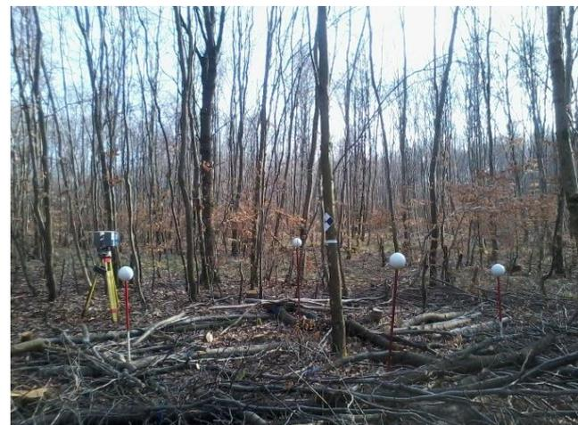
Figure 14: Acquisition d'une scène au LIDAR Terrestre
