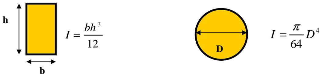
3) Calcul de la contrainte critique avant rupture d'une poutre circulaire.
