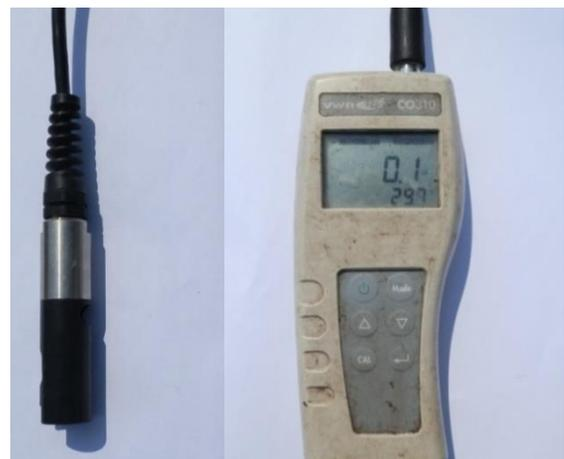
Figure 24 : Conductimètre VWR CO310
