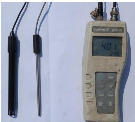
Figure 25 : pHmètre VWR pH110
