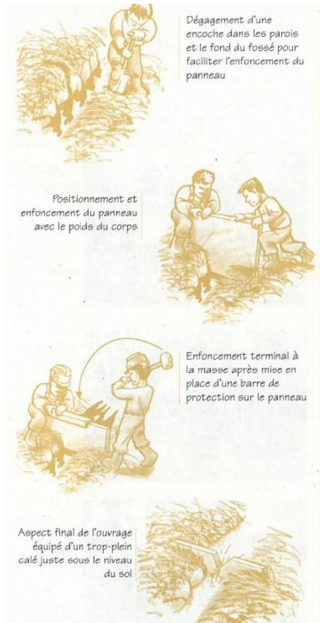
Figure 55 : Méthode d'installation des barrages-seuils en panneau de bois.
