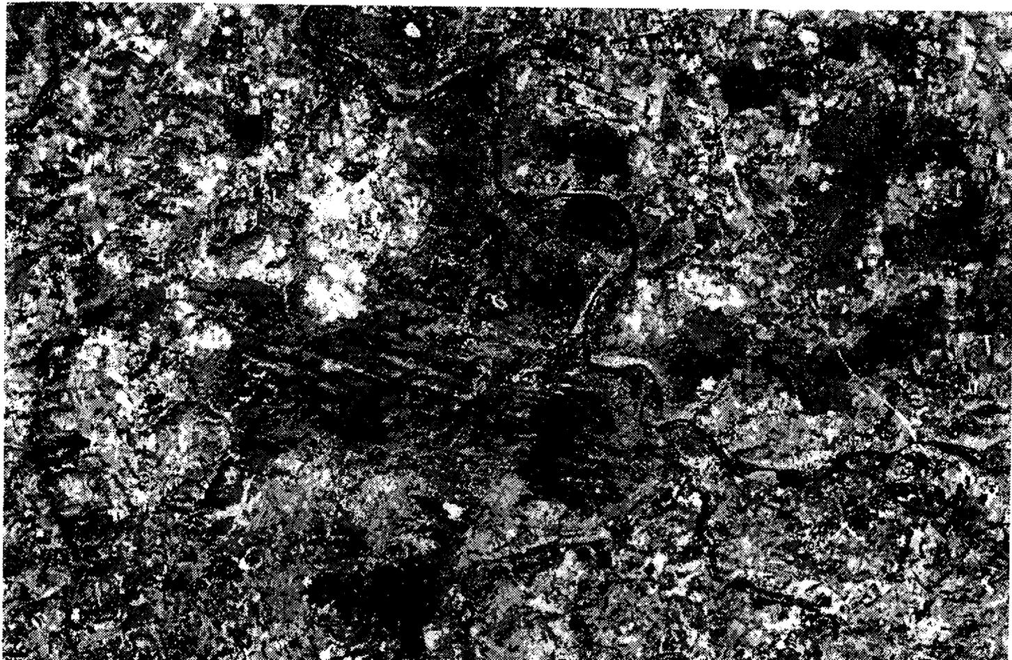
Le canal 6 (0,7-0,8 micromètre), situé dans le début du proche infra-rouge, permet de visualiser l'extension de la forêt et des bois alentours, les alignements gréseux, l'emplacement des carrières.
