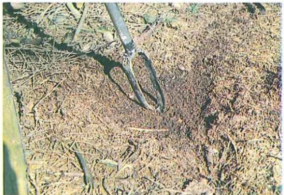
Une première carotte de terre est extraite. Elle est examinée, puis déposée sur le sol. Ici, on constate que la partie supérieure de la carotte est faite d'une terre brune et la partie inférieure d'une terre claire ; au toucher, cette terre s'avère être très limoneuse.
