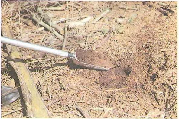
Une deuxième carotte est extraite ; déposée sur le sol dans l'alignement de la première, elle est suivie d'un troisième prélèvement. Ainsi, peut-on observer ici deux horizons nettement distincts, l'un brun et l'autre brun-jaunâtre ; le sol peu caillouteux est limoneux ; la profondeur explorée est de 65 cm.
