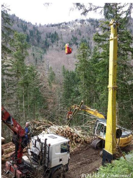
**Figure 21 : Débardage par câble-mât, machine en bas. Chantier de démonstration à Apremont (01).**
