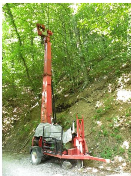
**Figure 22 : Câble-mât de petite dimension, monté sur remorque.**
