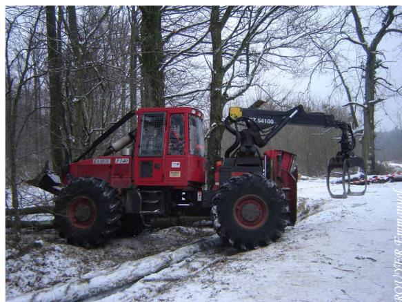
**Figure 15 : Débusqueur à grue travaillant sur sol gelé.**
