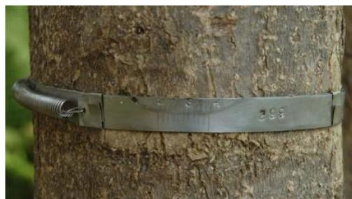
Figure 2: Dendromètre en ruban
