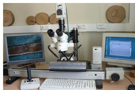
Figure 10 : Système de mesure Lintab
