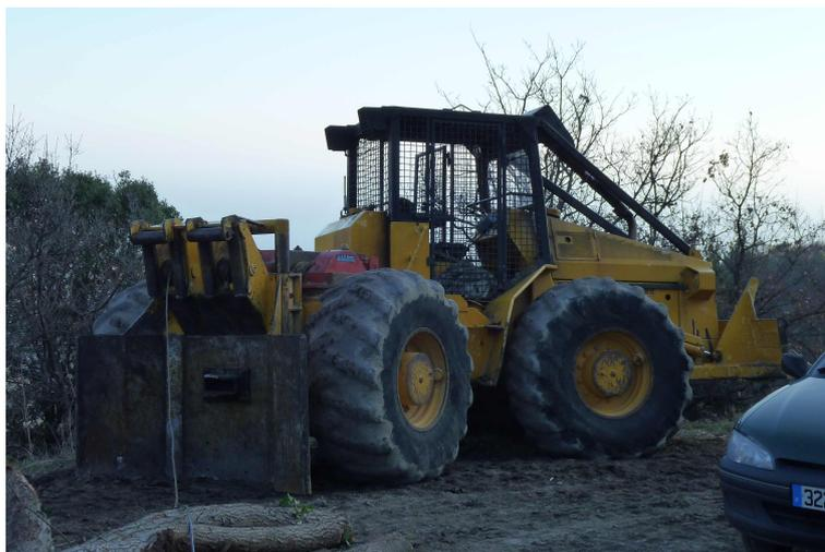
FIGURE 16 – Exemple d'un tracteur débardeur
