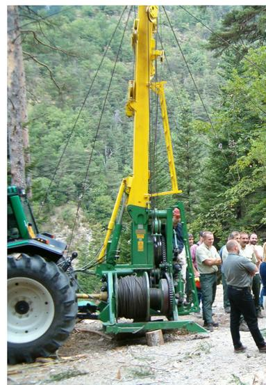
FIGURE 35 – Câble-mât sur tracteur
