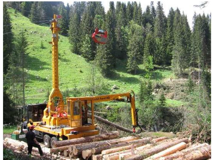
FIGURE 18 – Câble-mât sur remorque et sur camion combiné à une tête d'abatteuse
