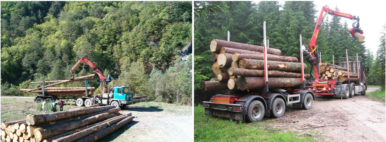
FIGURE 28 – Grumier traditionnel et camion double
