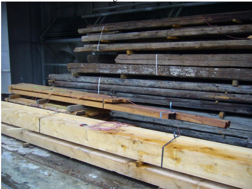
Figure n° 56 : Bois à l'intérieur du séchoir
