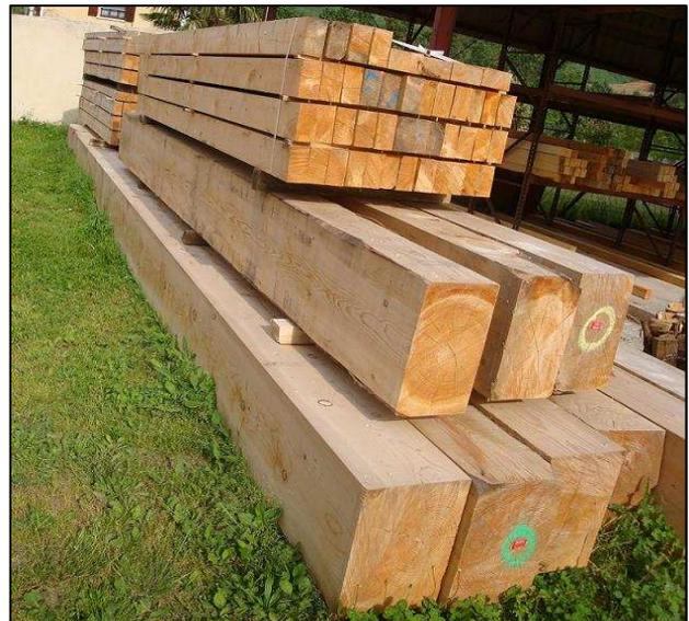
Photo 3 : Pièces de charpente en cèdre
