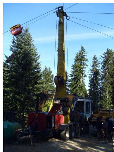
Figure 6: Débardage au câble mat.
