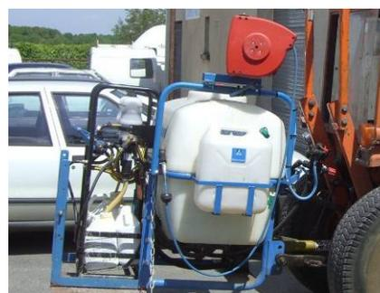
**Photo 10 : Pompes DOSATRON® et cuve d'eau claire**
