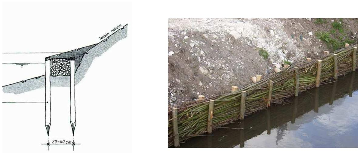
Figure 36 : Protection d'un pied de berge par fascinage (source : bureau d'études biotec)
