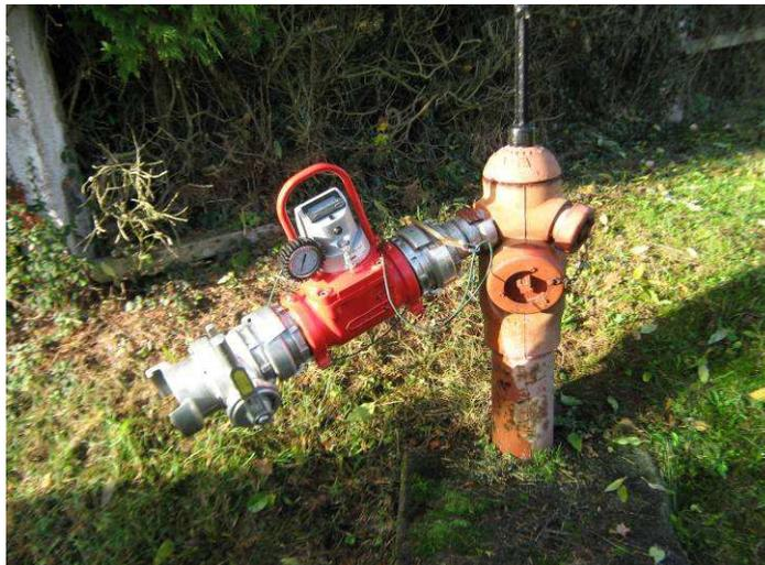
Certains poteaux ne possédaient qu'un diamètre de 65mm avec des pertes de charges plus importantes. On a précisé le diamètre de la bouche d'incendie et celui où a été effectuées les mesures. (voir courbes de chaque poteau).
