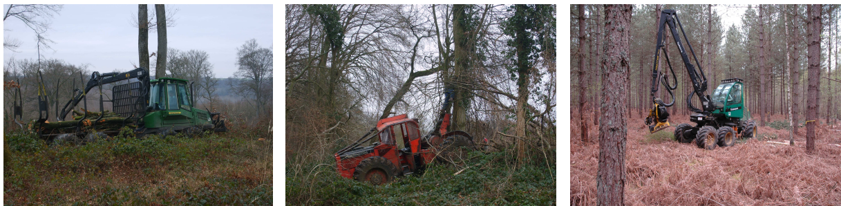
Figure 6 : Quelques engins forestiers classiques. Porteur et débusqueur en forêt de Retz (photographies : Laurent Renouf), abatteuse (photographie : Pascal Frbezar, ONF).
