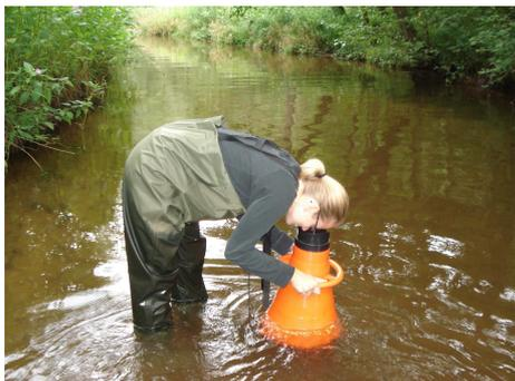
Photo 2 : Analyse du substrat à l'aide d'un aquascope
