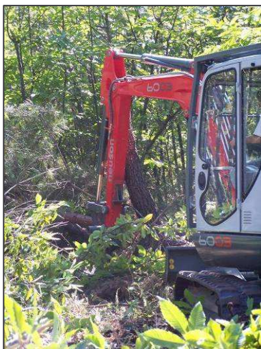
Figure 6 : Pelle mécanique munie d'une lame d'abattage Becker (CAFSA).
